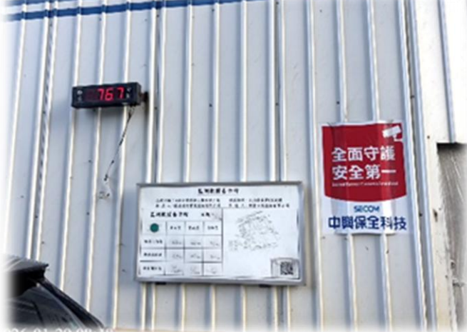
▲噪音管理及預防措施-噪音管制板
